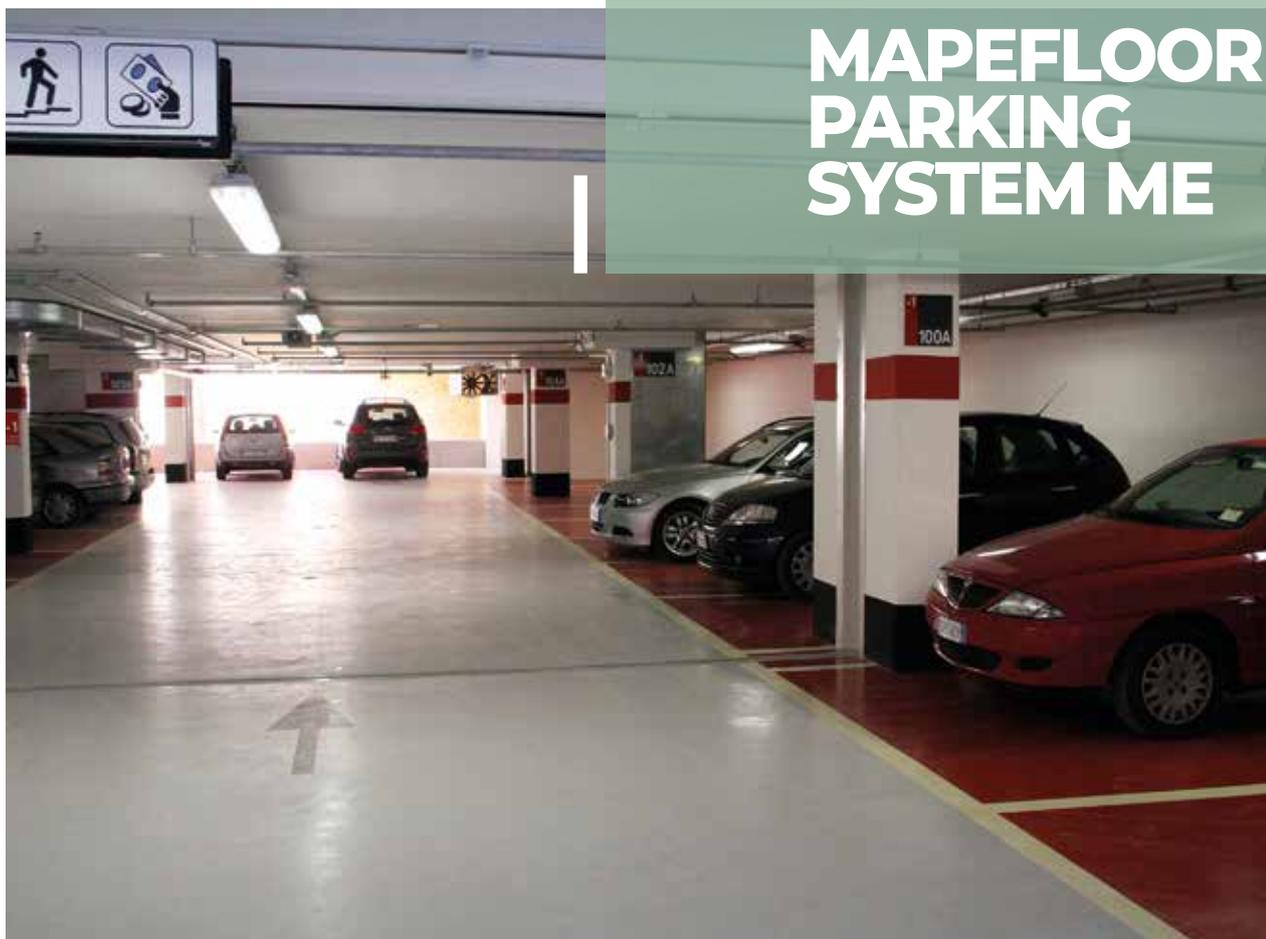
Sistema poliuretano multistrato continuo, per aree pedonali o carrabili soggette a traffico intenso, con elevata capacità di crack-bridging dinamico per la protezione di aree di parcheggio anche esterne, in accordo alle Guideline of the German Committee on Reinforced Concrete OS 11b e ai sistemi di protezione delle superfici in calcestruzzo secondo EN 1504-2. Spessore 4-4,5 mm.
