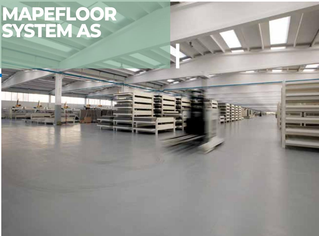
Sistema epossidico autolivellante, ad alto contenuto di solidi, per la realizzazione di pavimentazioni industriali antistatiche conduttive di spessore 1,5-2 mm.
