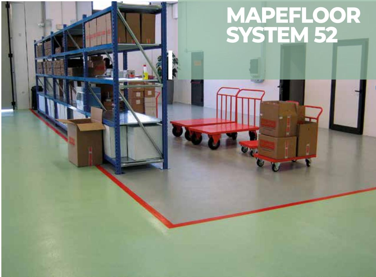
Sistema epossidico idrodisperso, opaco, multistrato, permeabile al vapore, con effetto antiscivolo per pavimentazioni industriali con 5 mm di spessore medio.
