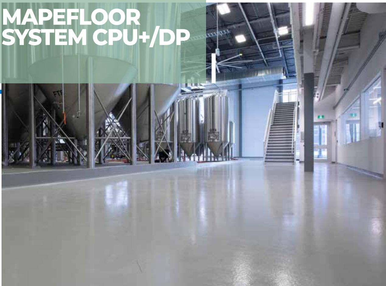
Sistema multistrato antisdrucchiolo a base di formulato poliuretano-cemento, ad alta resistenza chimica e meccanica, per rivestimenti di pavimentazioni industriali in uno spessore compreso tra 4 e 6 mm. Conforme agli standard per l'utilizzo in ambienti alimentari.
