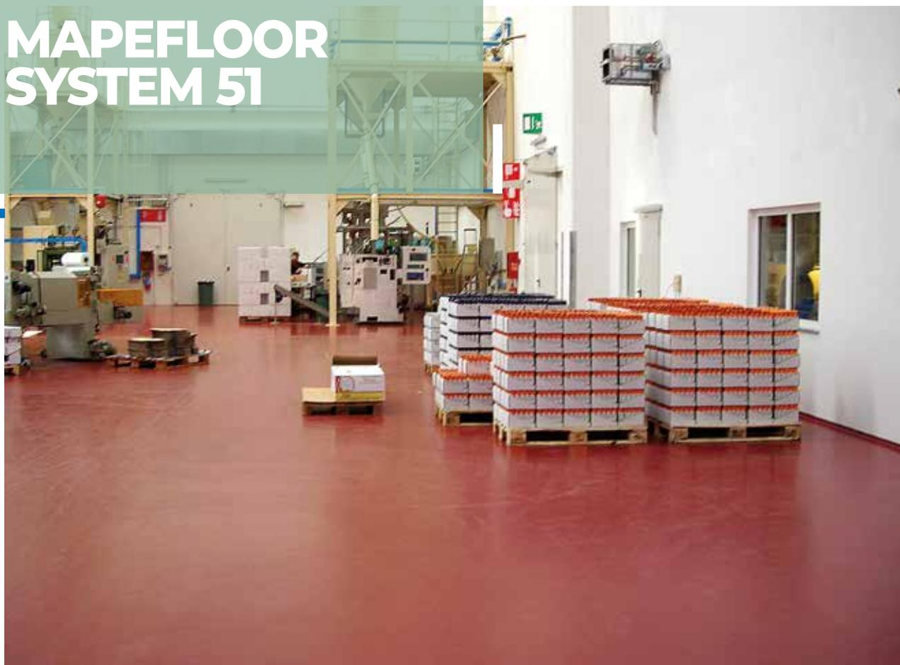
Sistema epossidico idrodisperso, opaco, multistrato, permeabile al vapore, con effetto antiscivolo per pavimentazioni industriali con 3 mm di spessore medio.
